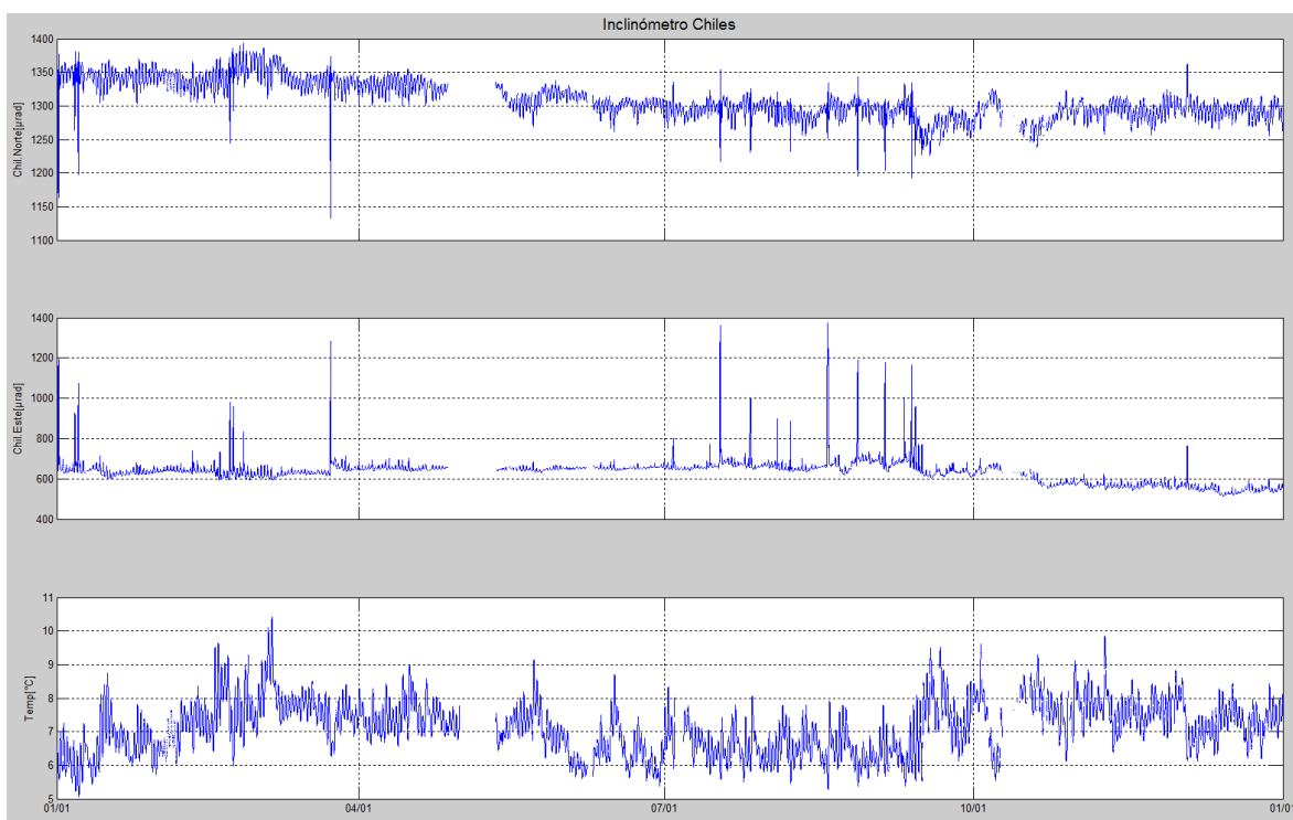
Figura 57. Componentes de inclinación Norte y Este, registro de temperatura del inclinómetro electrónico Chiles, instalado en el volcán del mismo nombre, para el periodo comprendido entre el 1 de enero de 2015 y el 31 de diciembre de 2015.
