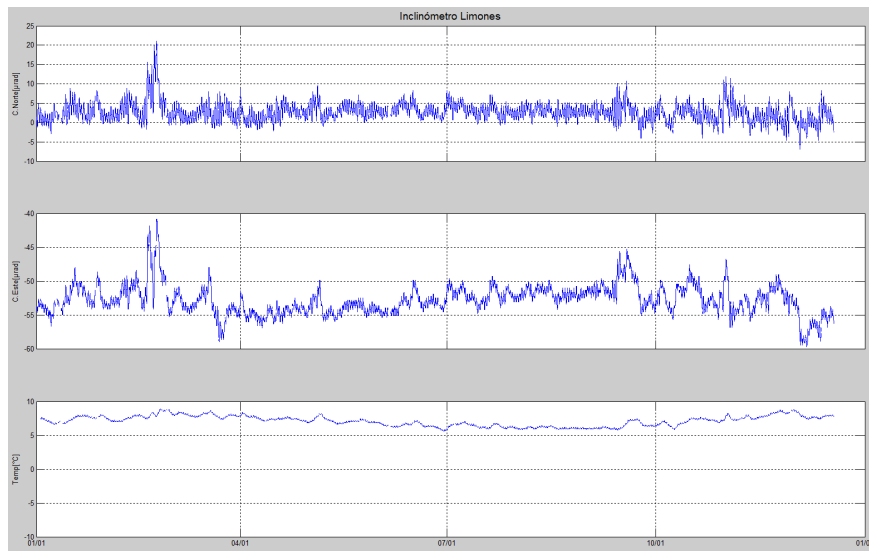
Figura 46. Componentes de inclinación Norte y Este, temperatura del inclinómetro Limones, instalado en el complejo volcánico de Cumbal, para el periodo comprendido entre el 1 de enero de 2015 y el 31 de diciembre de 2015.
